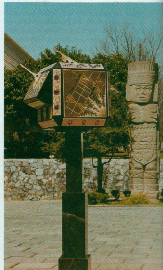
Vielflächensonnenuhr „Multihorum“ Marmor, Messing und Kupfer, mit fünf Zifferblättern. Alle Schattenwerfer stehen parallel zueinander
