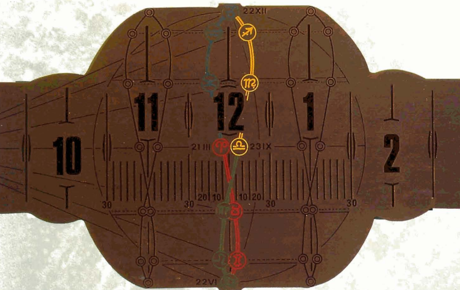
Figura 9. Fotografía de un reloj solar ecuatorial con doble carátula. Dependiendo de la estación del año, la sombra del indicador se proyecta en uno u otro lado del disco suspendido en el interior del anillo que rodea al reloj. Diseño: L.M. Loske 1985. (Fotografía: L.M. Loske).
