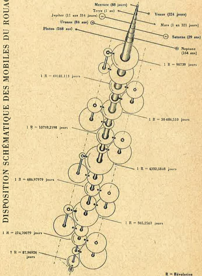
Abb. 5: Schematische Darstellung des Räderwerkes zu einem Planetarium von L. M. Loske.
